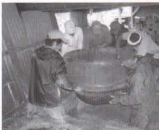
⑤叩き付けた粘土の上に釜を据え安定具合を確認しながら調整する。
